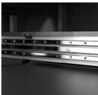
Guía lineal de doble fila, el eje X adopta guías lineales de doble fila, lo que hace que la impresión sea más estable y garantiza la precisión de la impresión.
