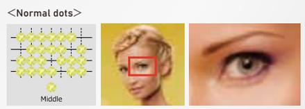
Los puntos se combinan con el tamaño mínimo de 4 picolitros para permitir una impresión en color suave con una sensación menos granular.
